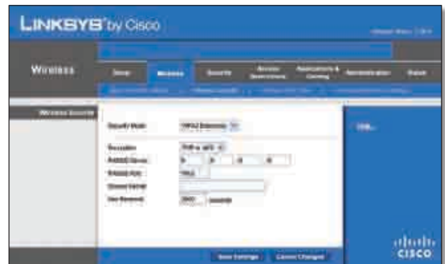
Security Mode (Beveiligingsmodus) - WPA2 Enterprise
